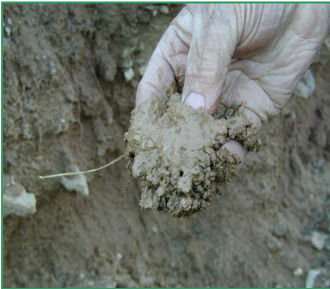
Terre utilisée pour la fabrication des tuiles (Terrer) Pallars (Paul Calvet)
